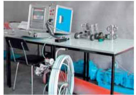
„Kamera zur Kanalbefahrung“
